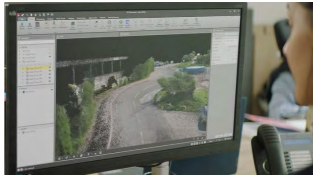
写真4: Infinity後処理解析ソフトウェア上に写真を取り込むことにより点群を生成し、TINメッシュなどを作成することも可能
