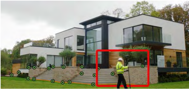
写真2: GS18 Iを活用しながら、建物周辺を歩くことにより、凹凸部分を写真イメージより自動検出し、複数枚の写真を重ね合わせて正確な位置を特定
