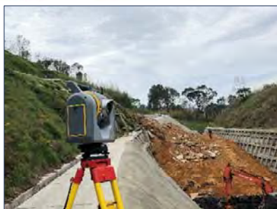
点高法で算出された崩落土量（完成形状をベースとした土量算出）
