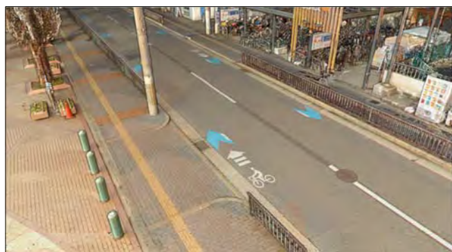
グレーチング、歩道エッジ、タイル目地も鮮明 写真のように綺麗な点群データ（NavVis MLX）
