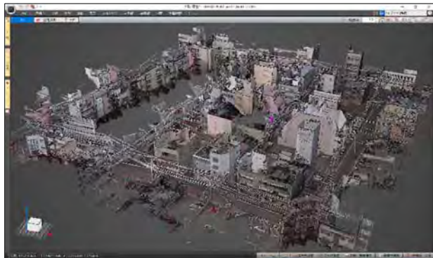
図-1 LidarSLAM による広範囲の時短計測
